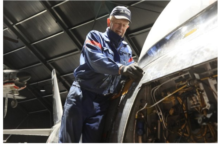
Også på F'en ble boltene skjeve under prøveløftingen, nye måtte lages. Festepunktene på flyet måtte prepareres for å få en større og bedre anleggsflate. Her er Kjell Naas i gang med prepareringen
