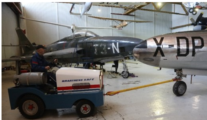
Vi har en gammel tauetraktor fra Braathens. Den har Volvo motor, går på propan, og klarer greit å trekke de mindre flyene.
