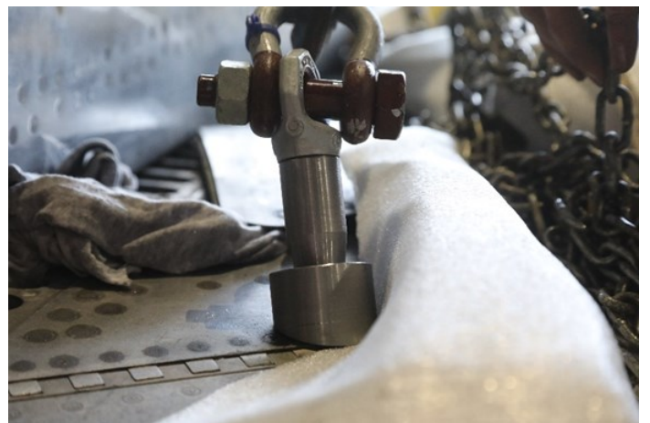
Nye bolter ble laget med en større anleggsflate mot vingene, samtidig som vinkelen på flyet ble redusert. Da gikk det greit.
