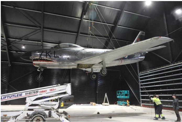
Selv om utvekslingen er stor på kjetting taljene er det tungt arbeid å få opp flyet med to taljer
