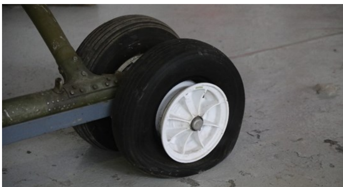
Å la utstillingsgjenstandene stå på hjul er ikke heldig i det lang løp. Her et eksempel på et dekk som er blitt ødelagt etter å ha stått stille i mange år uten å bli ettersett.
