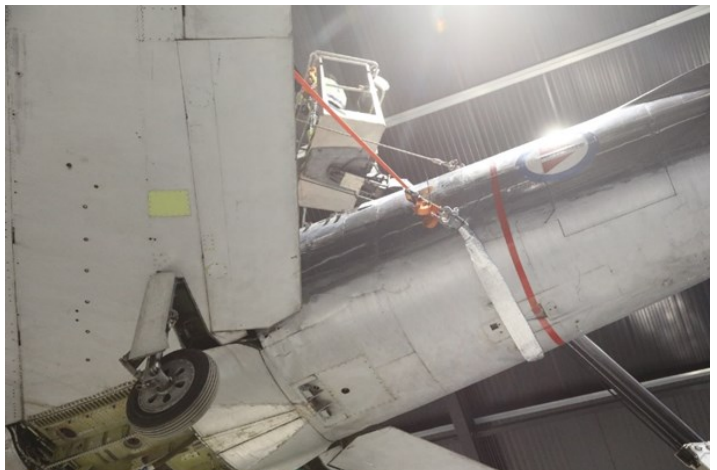
Det ble lagt magebelter under begge flyene. Det er de fabrikkinnstalterte heisepunktene på flyene som er det primære opphenget, men som ekstra sikring er det lagt magebelter under begge flyene.
