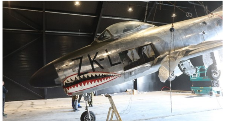
Så fulgte en prøveoppheng av K'en. Som det fremgår av bildet, ble den da hengt opp med nesene pekende bratt nedover. Det viste seg at helningen på flyet ble i meste laget, og boltene ble bøyd.
