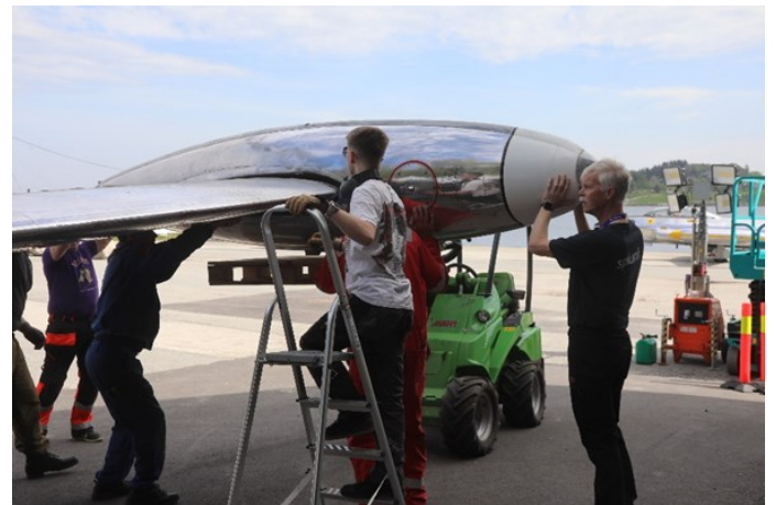
Først ble det forsøkt å ta av tankene. Men det gikk ikke. Så det endte med at den måtte lirkes inn ved å skyve den litt frem og litt tilbake inntil den smøg inn.
