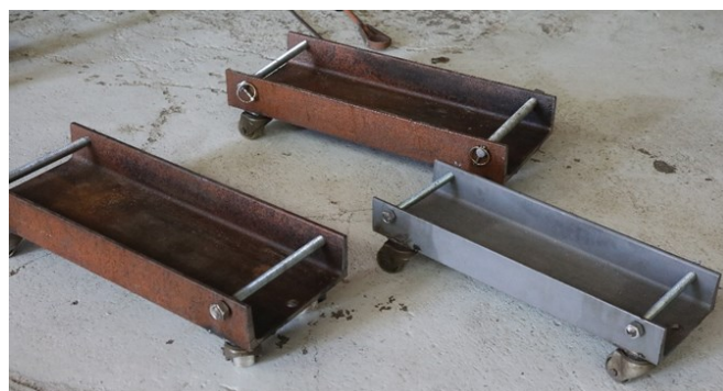
Kjell laget 3 slike, et for hovedhjulene og et for nesehjulet. De fire hjulene kan dreies i alle retninger, og boltene hindrer at flyene triller av.
