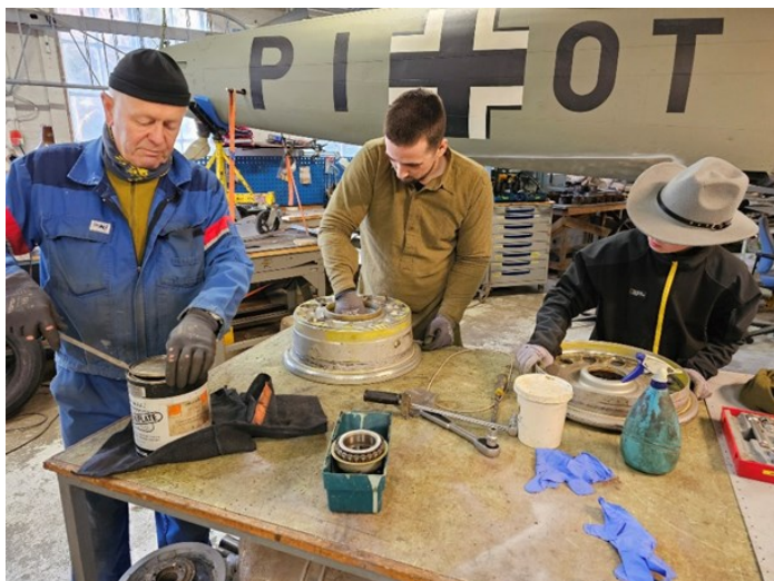
Som så måtte av, og felgene pusses, før det dekken igjen kunne settes på. Dette var en lang prosess som gikk over flere uker slik at bordet som ble brukt fikk navnet hjulebordet
