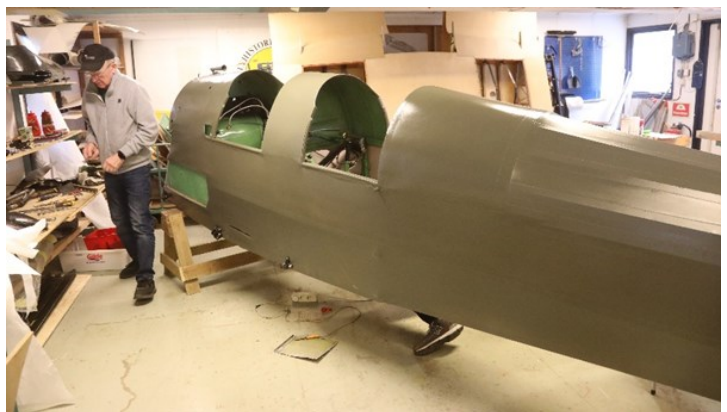
Den første delen av arbeidet gjøres i snekkerboden, og er å montere på alle beslagene
