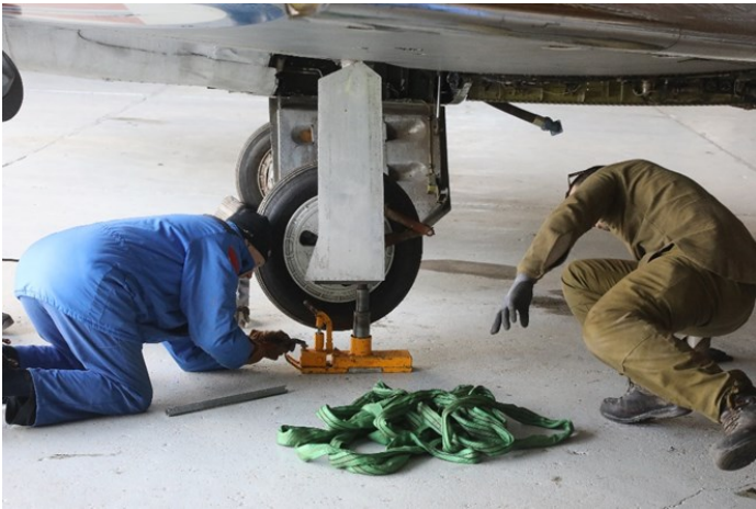
Hjulet må jekkes opp for å få satt dekket på
