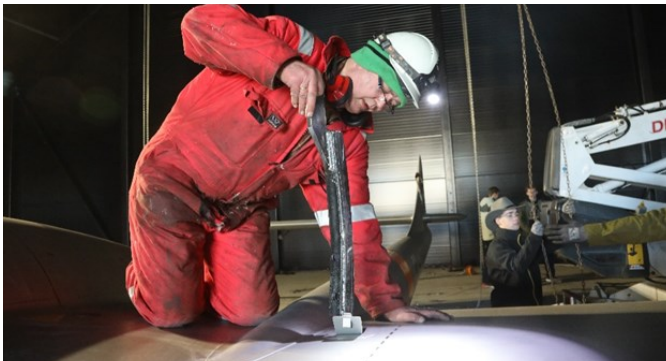
Spesialkonstruerte løfteinnretninger monteres til hjulstagene og går gjennom vingene
