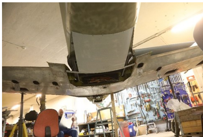
Tilpassing av plater på undersiden.
