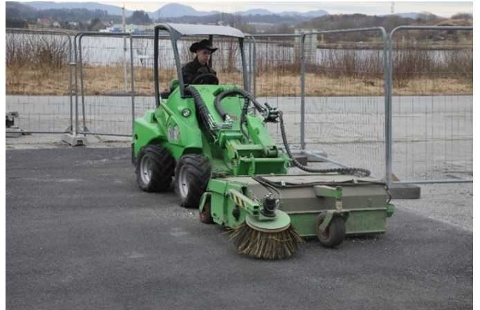
Sola vgs «lille grønne» er også utstyrt med et sopearangement som ble satt på for å sope området hvor DC 5 B skal stå
