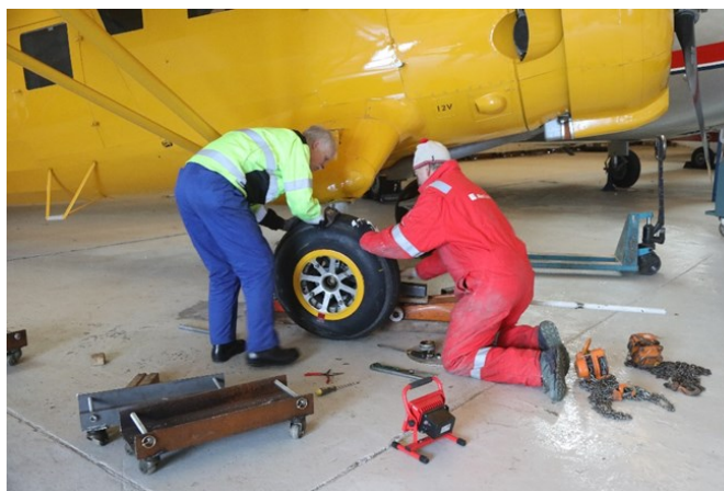
Kjell laget 3 slike, et for hovedhjulene og et for nesehjulet. De fire hjulene kan dreies i alle retninger, og boltene hindrer at flyene triller av.
