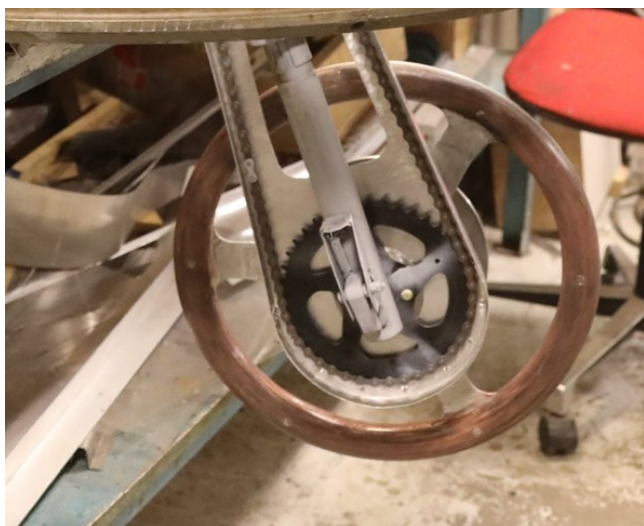
Detalj av mekanismen som brukes til å rotere tårnet
