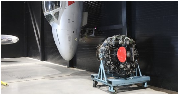
Goblin motoren er kommet på plass ved siden av Vampire, som var utstyrt med motor av denne typen
