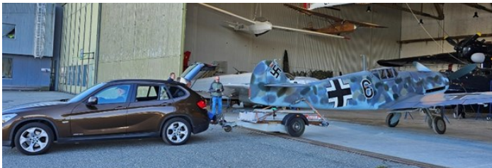
For å slepe Bf 109 ble halehjulet festet til en tilhenger
