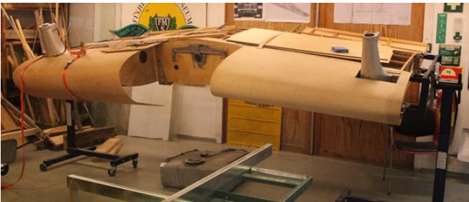
Senterseksjonen av vingene. Den ytterste delen av begge vingene er bygget.
