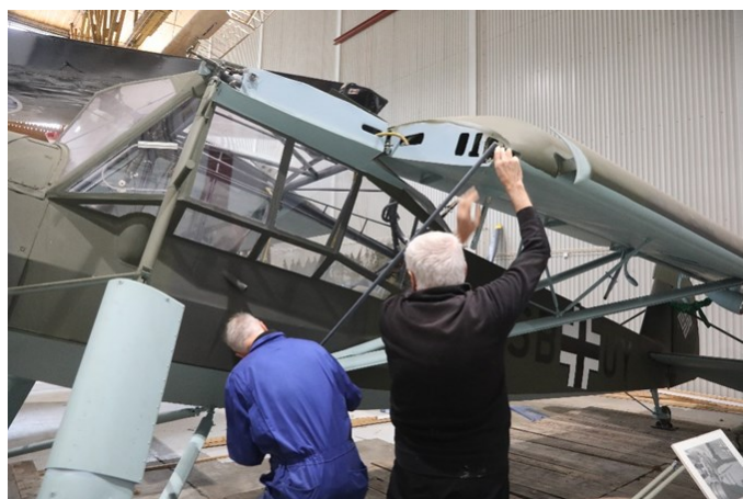
Til slutt blir det satt på stag som holder vingen i posisjon langs flykroppen.
