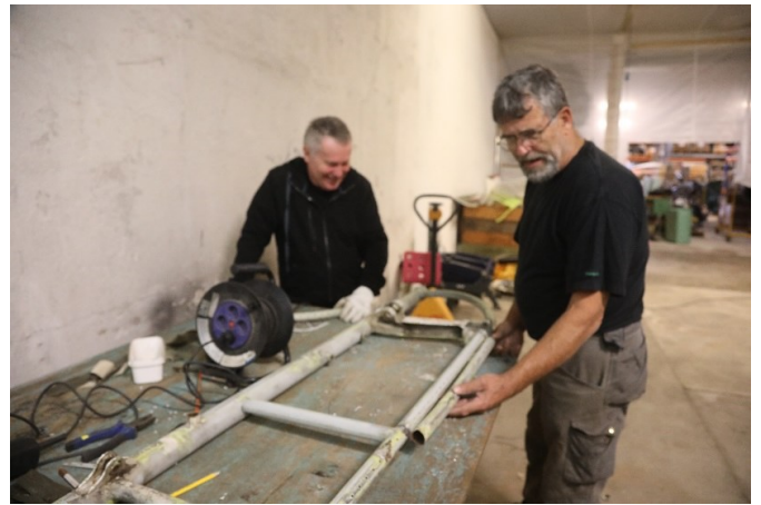
Terje Lange og Roar Ingebretsen arbeider med opphengenget for flyteelementene
