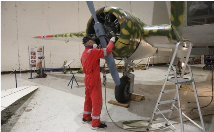
Litt avsluttende kamuflasje på undersiden av motorcowlingene
