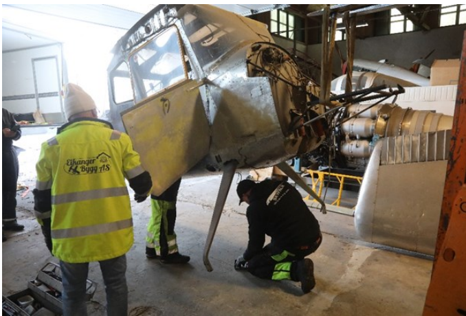
Hjulstagene og motorbukkene måtte av.
