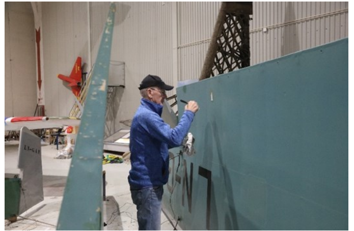
Flyet hadde noen mindre skader på duken da det kom som Siegfried utbedret
