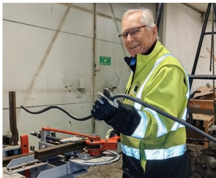
Egil Thomsen tilpasser hydraulikkør etter det som finnes av bilder g tegninger
