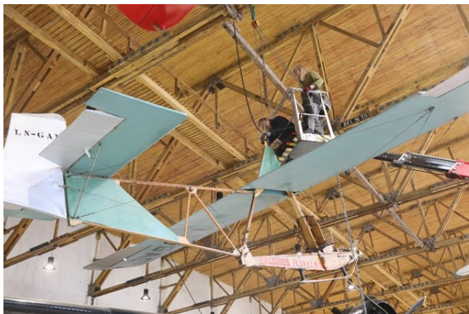
Deretter heises det opp med kjetting talje. Deretter overføres det til et sertifisert oppheng.
