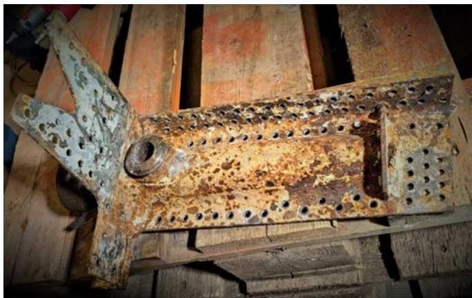
Vingefeste etter to døgn i elektrolysebad
