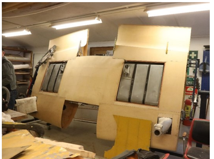
Senterseksjonen var langt på vei da arbeidet ble stoppet, nær drivstofftankene montert.
